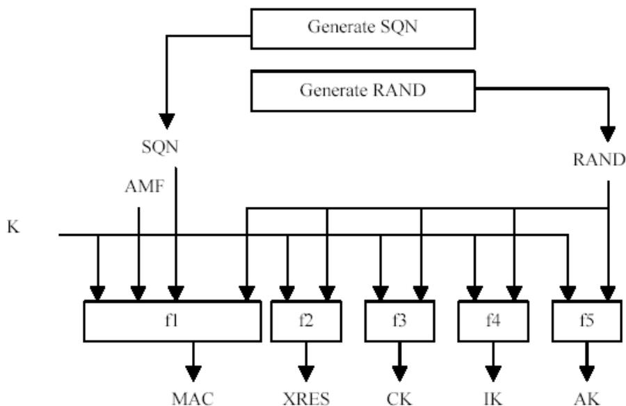
Рисунок 3.3 – Исходный алгоритм генерации вектора аутентификации
