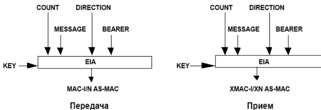
Рисунок 3.11 – Алгоритм проверки целостности в E-UTRA
