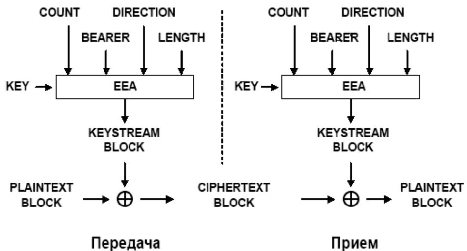
Рисунок 3.10 – Алгоритмы шифрации и дешифрации в E-UTRA
