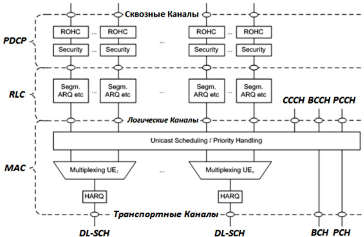
Рисунок 2.1 – Структура уровня L2 при передаче вниз
