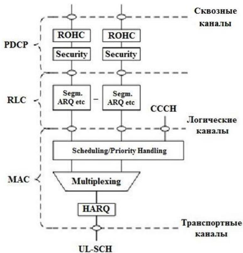
Рисунок 2.2 – Структура уровня L2 при передаче вверх
