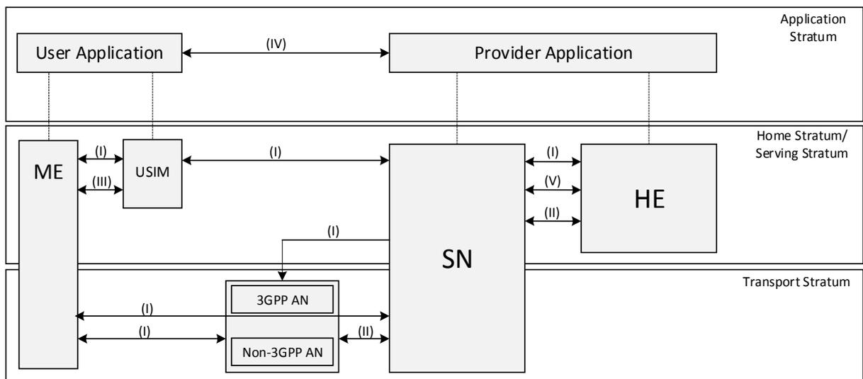
Рисунок 4.3 – Базовая структура безопасности в сетях 5G
