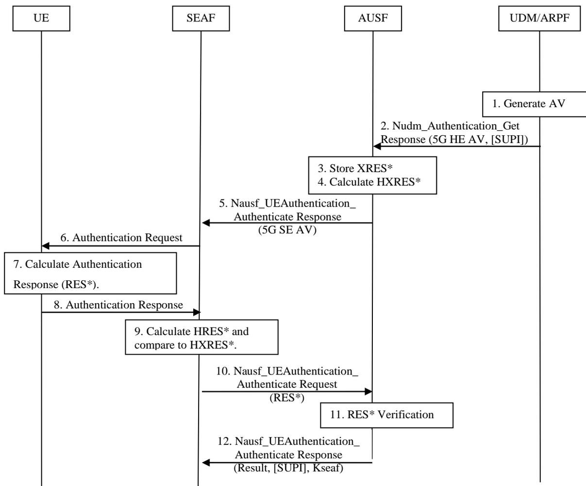
Рисунок 4.8 – Процедура аутентификации по алгоритму 5G-AKA
